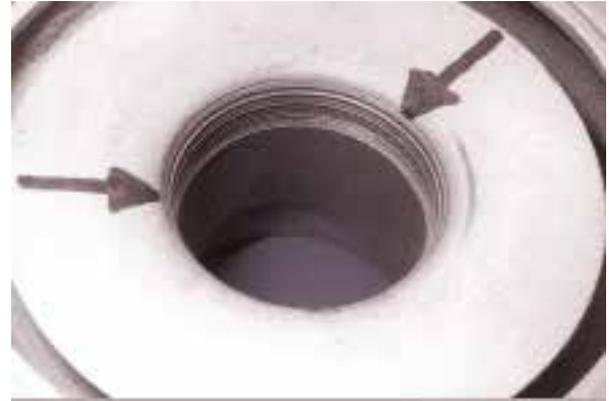
Con el aumento de temperatura que se emite, los casquillos se recalientan considerablemente. Entonces se dilatarán, lo que comportará un contacto físico entre el casquillo y la caña del eje, así como un depósito de cobre que será perfectamente visible.
