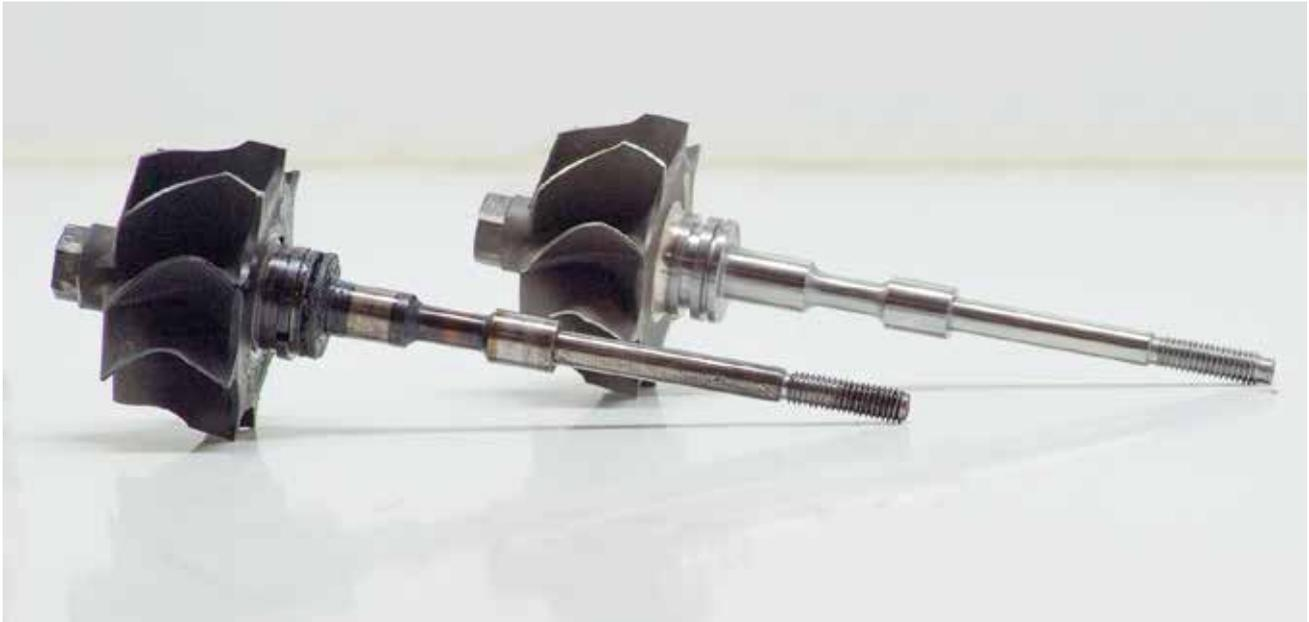
Por contaminación, también se entiende la carbonización del aceite lubricante. El aceite carbonizado se puede pegar en el interior del cuerpo central y de esta forma bloquear los dispositivos de estanquidad del aceite, con el riesgo de una fuga de aceite. La carbonización del aceite puede también ocasionar desgastes en los casquillos y en los dispositivos de estanquidad.
