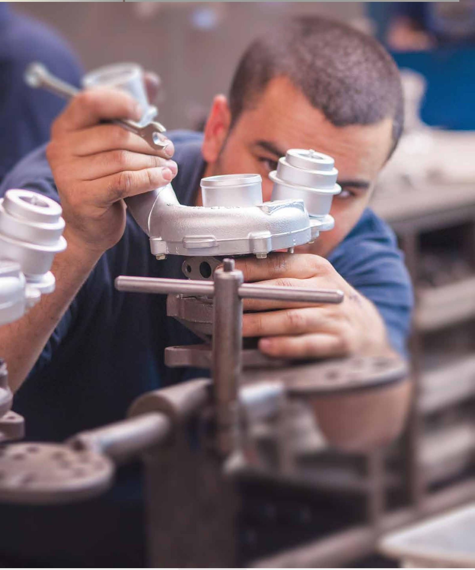
Turbo Matic proporciona turbocompresores revisados para cada tipo de motor. El taller conoce cuatro disciplinas especializadas: limpieza, tratamiento de superficie, control y equilibrado. Estas cuatro disciplinas velan para que un turbocompresor revisado iguale o hasta incluso supere la calidad de un turbo nuevo.
